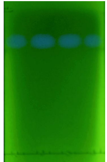
Abbildung 26 DC-Platte, bevor das Laufmittel verflüchtigte (Salicylsäure gibt blau im Laufmittel unter UV an, Kontrast wurde erhöht)
