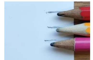
Abbildung 24 Strichförmige Verunreinigung knapp über Acetylsalicylsäure Eichlösungen (v.l.n.r. 1, 5 & 10 µg)
