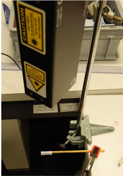
Abbildung 25: Fixation des Probestücks und aufgebauter digitaler Newtonmeter.
