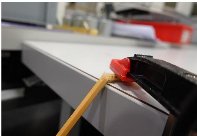
Abbildung 28: Bruch des Bambusrutensegments
