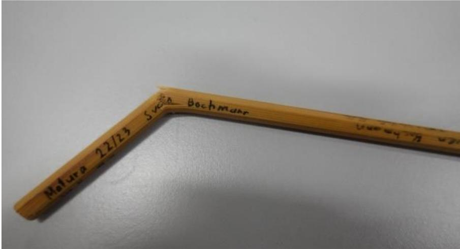
Abbildung 29: gebrochenes Bambusrutensegment
