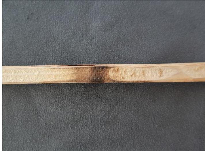
Abbildung 7: Erwärmen der Knoten    Abbildung 8: geradegebogener Streifen
