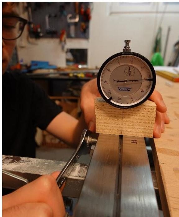
Abbildung 11: Mit Hilfe einer Tiefenlehre wird die Tiefe der Kerbe gemessen und die Stellschrauben mit dem Schraubenschlüssel eingestellt.
