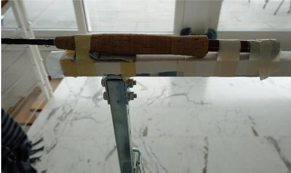
Abbildung 20: Die auf einem Gestell befestigte Fliegenrute bereit zum Testen
