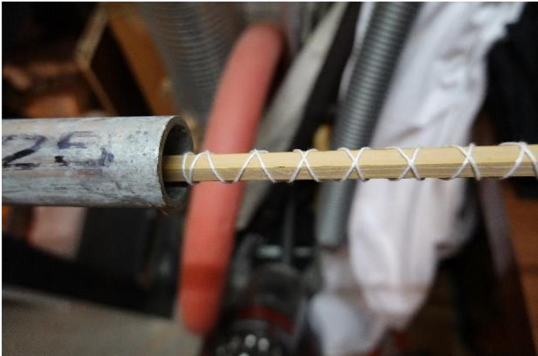
Abbildung 10: Hitzebehandlung des Bündels in Metallrohr
