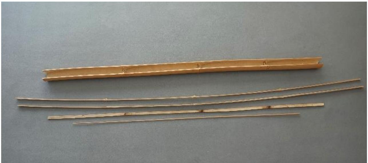
Abbildung 5: Die verschiedenen Stadien vom rohen Bambusrohr (oben) bis zum fertig gehobelten Bambus-Streifen vor dem Verleimen (unten).
